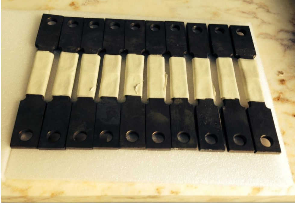
Fotoğraf 4. 3. SE-interkonnektör çekme testleri için hazırlanan numuneler
