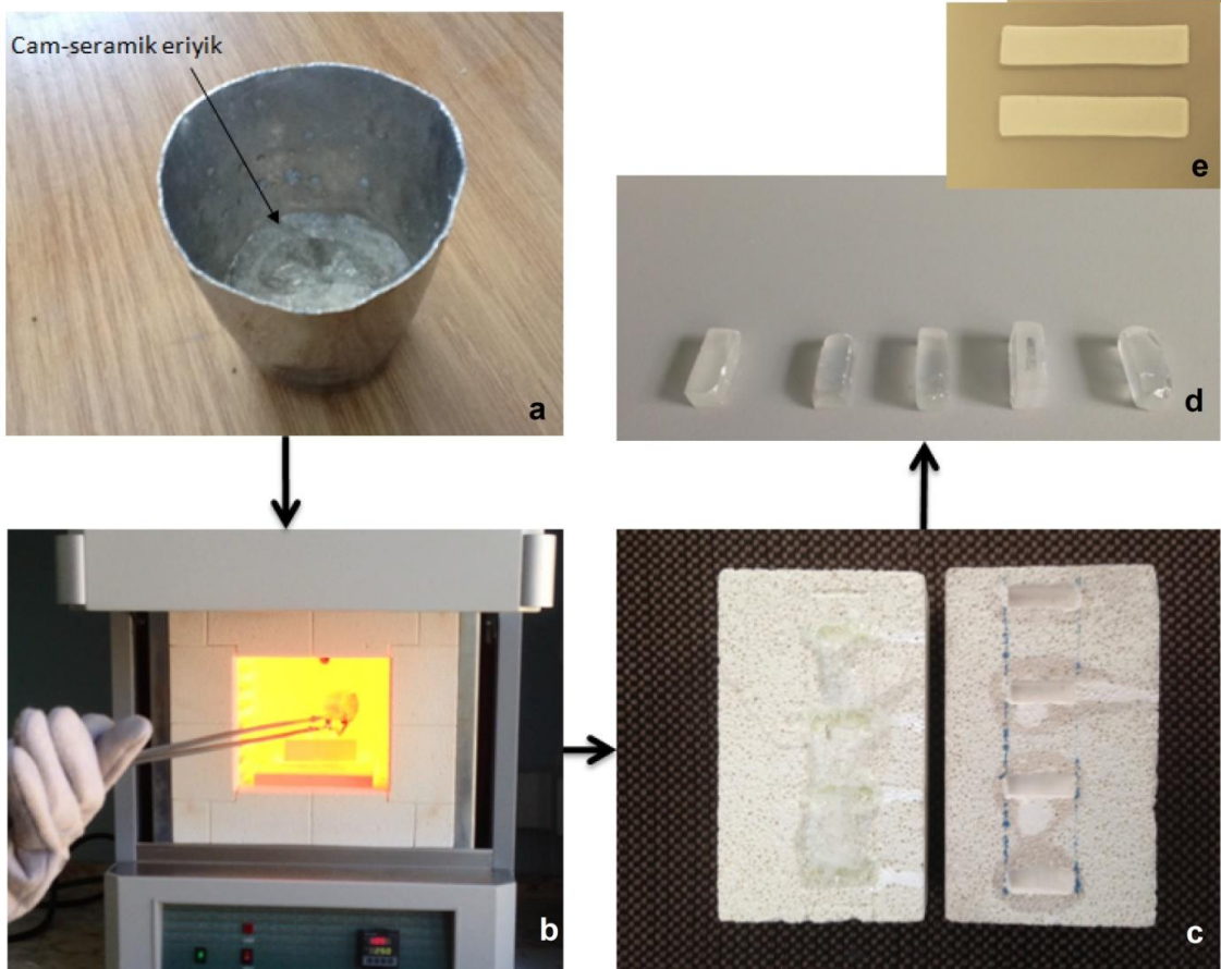
Fotoğraf 4. 2. Cam-seramik karışımından numune üretim aşamalarının fotoğrafları a)1500°C'de pişirilmesi sonucu eriyiğin görünümü, b)Numunelerin 1500°C'de pişirildikten sonra 1300°C'de dökümünün yapılışı, c) soğuyan kalıp d) kalıptan çıkarılan numuneler ve e) eğilme test numuneleri
