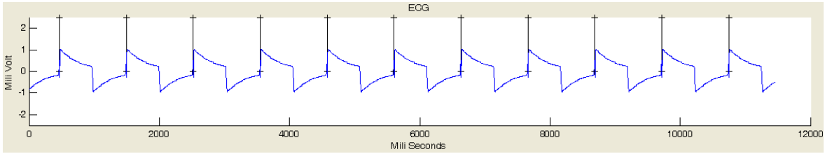
Şekil 4.21 Ortamda telsiz telefon çalışması sonucu oluşan sinyal.
