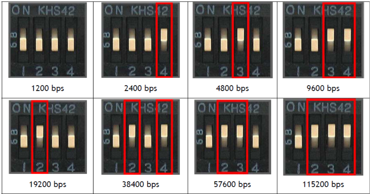
Şekil 3.23 2. anahtar grubundaki bacakların konumuna göre iletim hızları [42].
