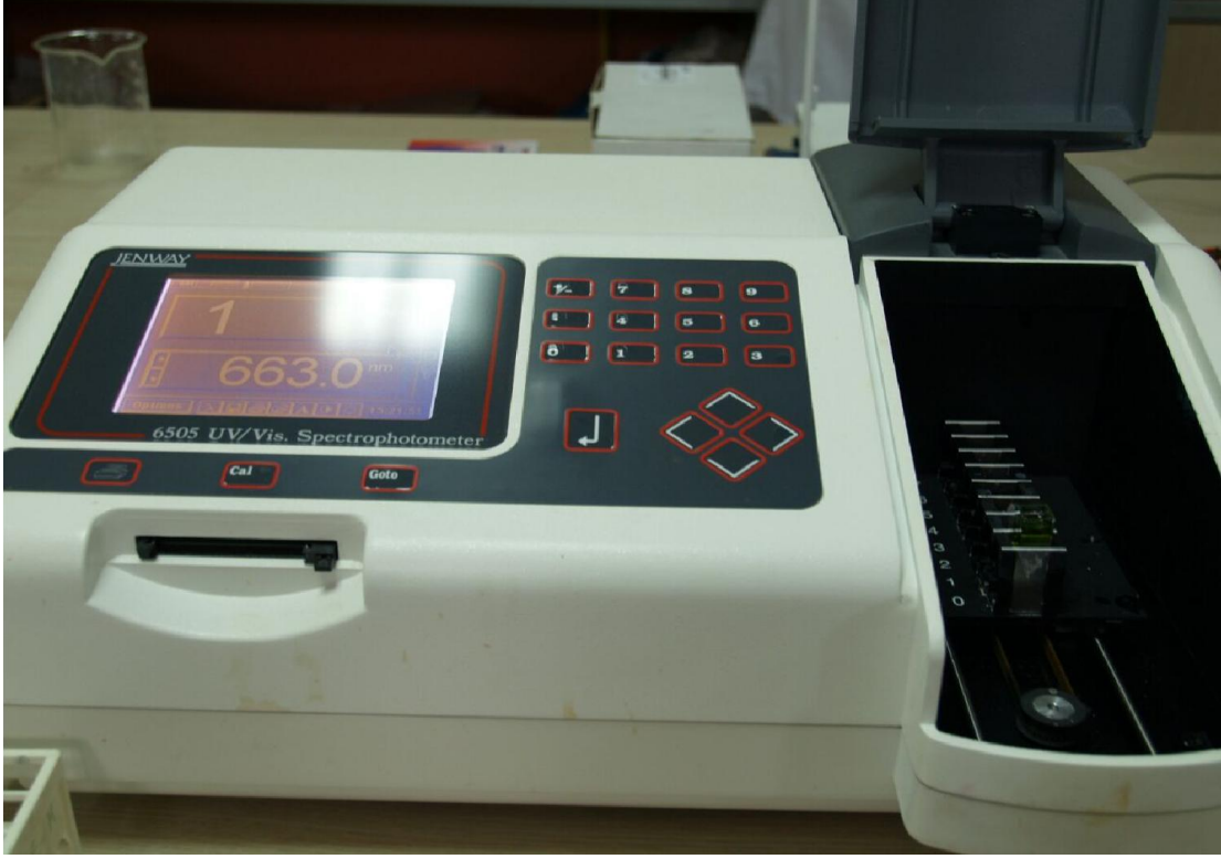
Fotoğraf 2.6. Elde edilen ekstraksiyonda absorbans deęerleri jenway 6505 u.v. spektrofotometresinde ölçülmesi
