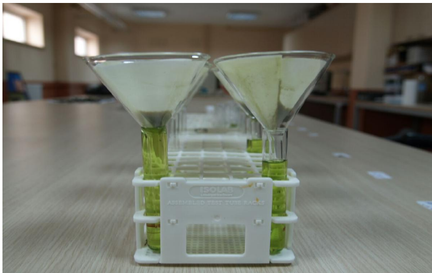
Fotoğraf 2.4. Filtre kağıdı kullanılarak örneklerin süzölmesi
