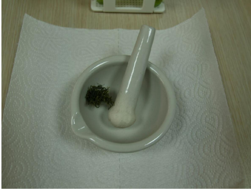
Fotoğraf 2. 3. Örneklerin aseton ile homojenize edilmesi
