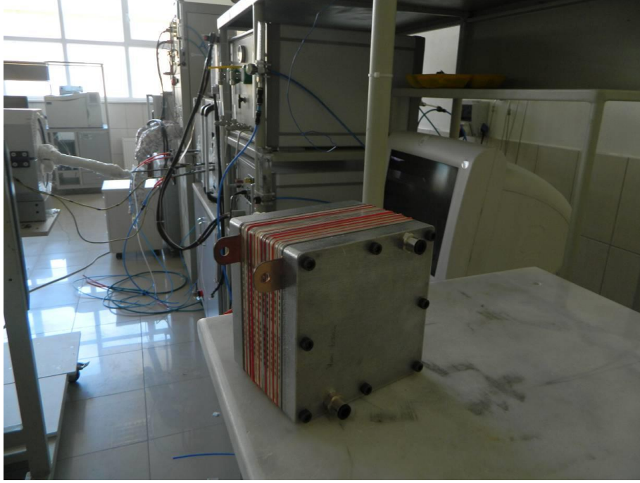
Foto 5.7. Yeni tasarım alüminyum plakalardan oluşan 10 hücreli yakıt pilinin görünümü
