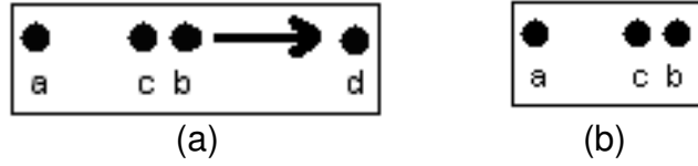
Şekil 2.7 (a) Uzak düğüm bağlantısı sağlanmadan önceki durum, (b) Uzak düğüm bağlantısı sağlandıktan sonraki durum.
