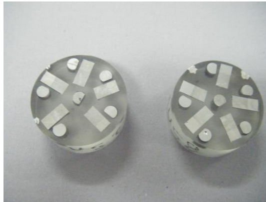
Şekil 3.15 Epoksi-resin ile kalıplanan numuneler
