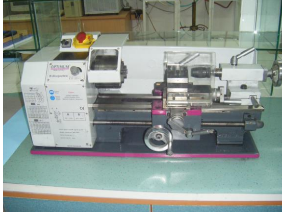
Şekil 3.6 Numune kalıplarının hazırlanmasında kullanılan tornanın fotoğrafı
