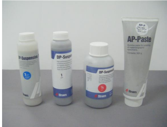
Şekil 3.18 Parlatmada kullanılan elmas süspansiyonlar
