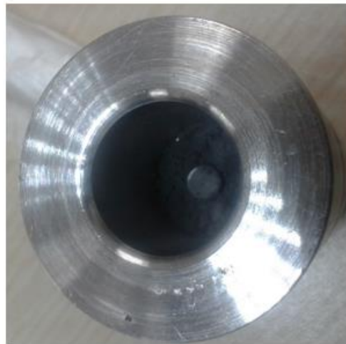
Fotoğraf 3.9. 16 mm çapında çelik haznenin içine yerleştirilen tohum
