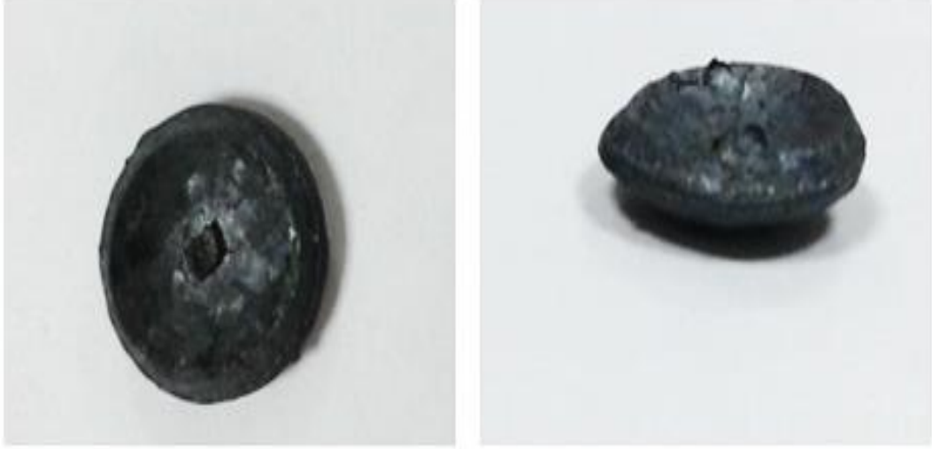
Fotoğraf 3.6. Üstten tohumlama yöntemi ile üretilen Sm123 tohumlu Y123 numunesinin altına yerleştirilen MgO peletinin numuneye etkisi
