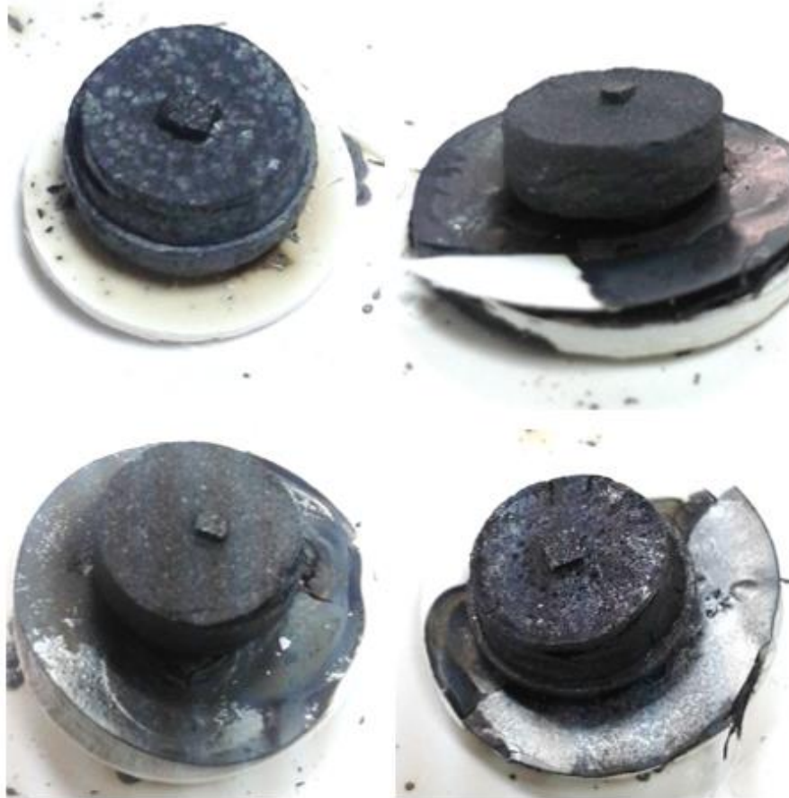
Fotoğraf 3.7. Üstten tohumlama eritme büyütme yöntemi ile üretilen örnekler
