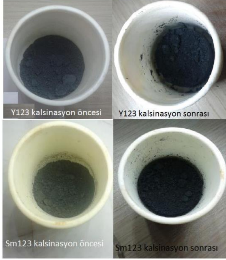
Fotoğraf 3.2. Kalsinasyon öncesi ve kalsinasyon sonrası Sm123 ve Y123
