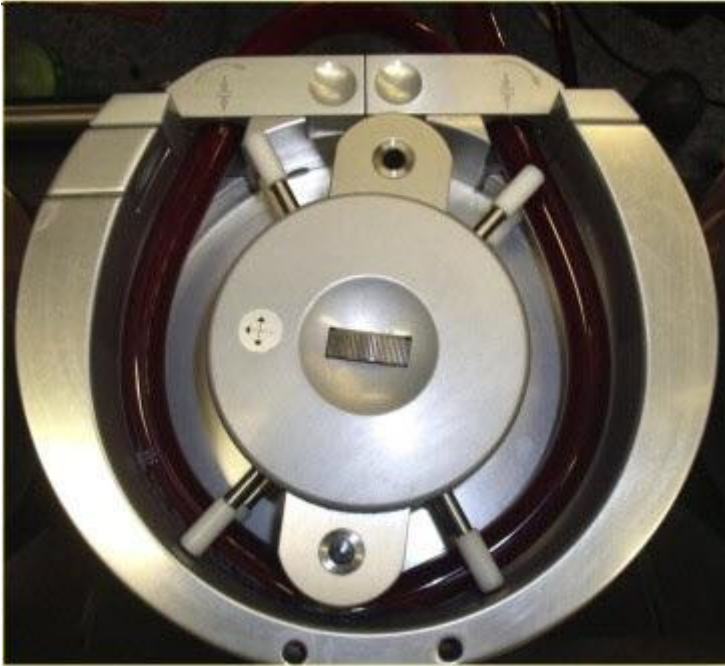
Şekil 2.2 Tipik silindirik roller pompa[126].
