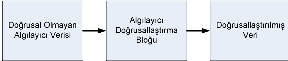
Şekil 2.1 Algılayıcı doğrusallaştırma akış diyagramı
