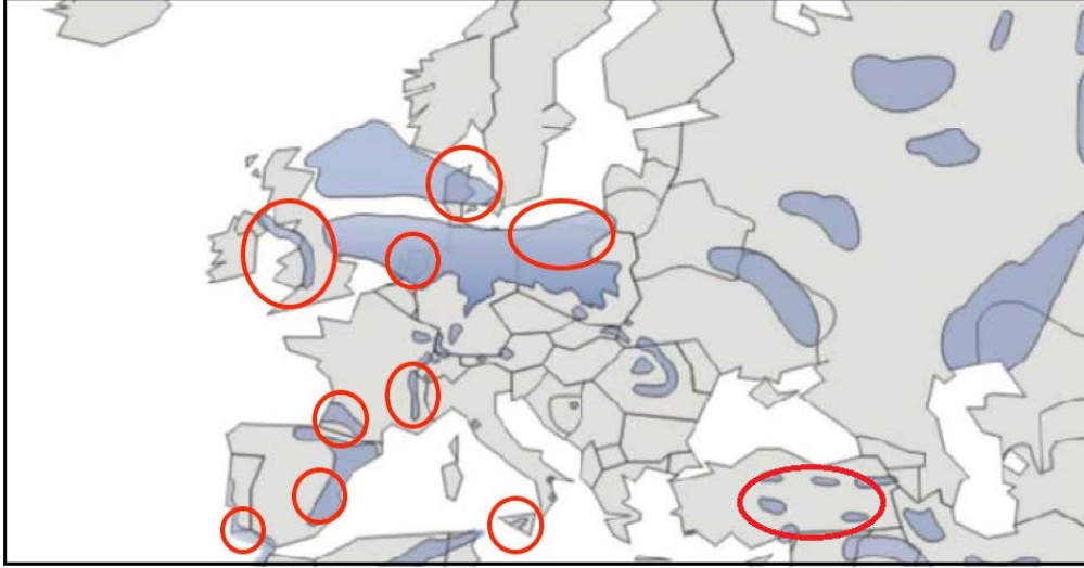
Şekil 5. Kaverna için Avrupa-Orta Asya Tuz Yataklarının Gösterimi (BAAR C.A.,1997)
