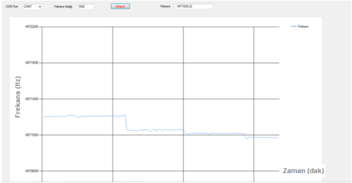
Çizelge 3.3 Akışölçer sisteminin oluşturduğu sıvı hız eğrisi
