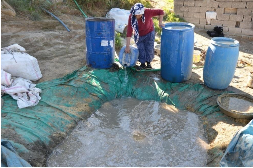
Foto 39: Havuza Atılan Tandır Toprağının Suyla Karıştırılması.
