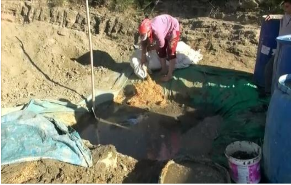
Foto 41: Dinlenen Tandır Çamuruna Saman Karıştırılması.
