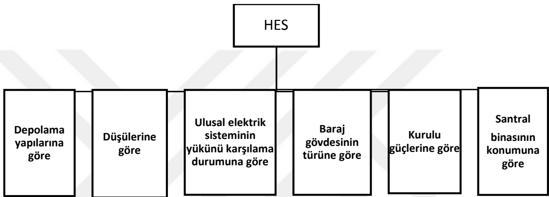
Şekil.12. Hidroelektrik santrallerin (HES) sınıflandırılması
