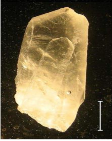
Şekil 2.11 Kuvars kristalin kesilmeden önceki yapısı [33]
