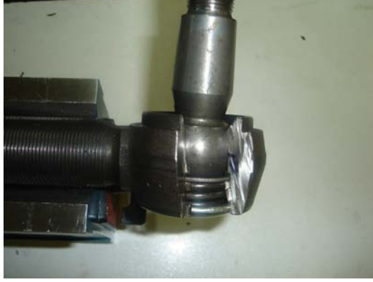
Şekil 2.2. Rot Başının Kesit Görüntüsü
