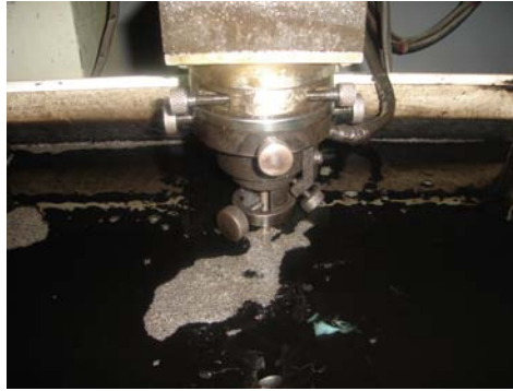
Şekil 6.1. Erozyon İşlemi İle Kalıp İşlenmesi
