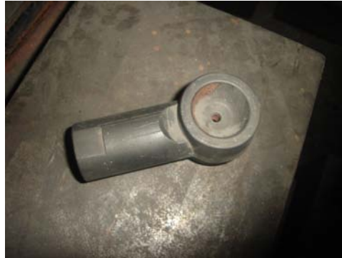
Şekil 5.5. Kalıp Hazırlanmasında Kullanılan Bakırdan Yapılmış Numune Parça
