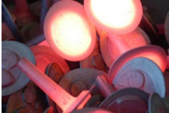
Şekil 5.1. Çeliğin Dövülme İşlemine Hazırlanması
