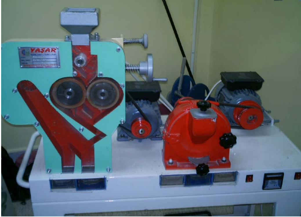
Şekil 3.4. Çeltik randımınının saptanmasında kullanılan ekipman
