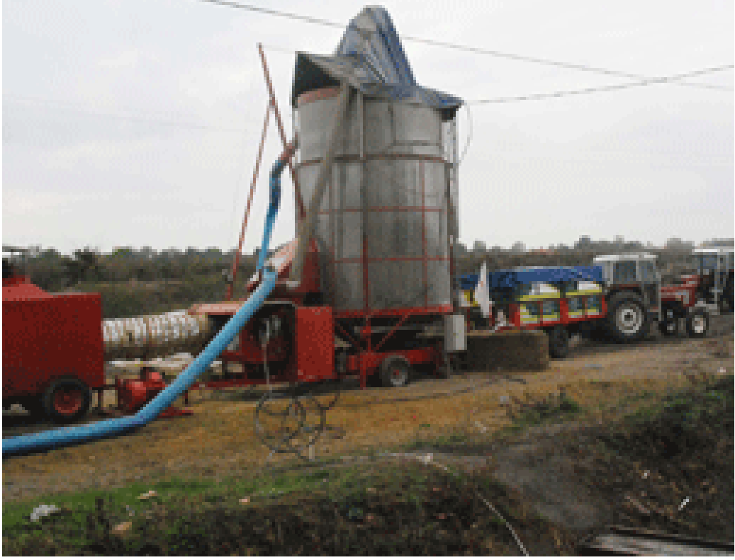
Şekil 3.9. Çeltiğin kurutucuda kurutulması
