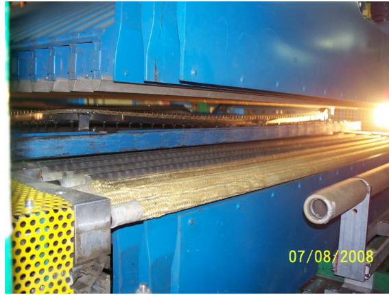
Şekil 4.3. Özel cam taşıyıcının camı alarak hava panosuna götürmesi
