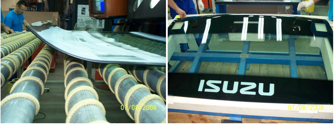
Şekil 4.4. Camın soğuması ve gabari kontrolünün yapılması
