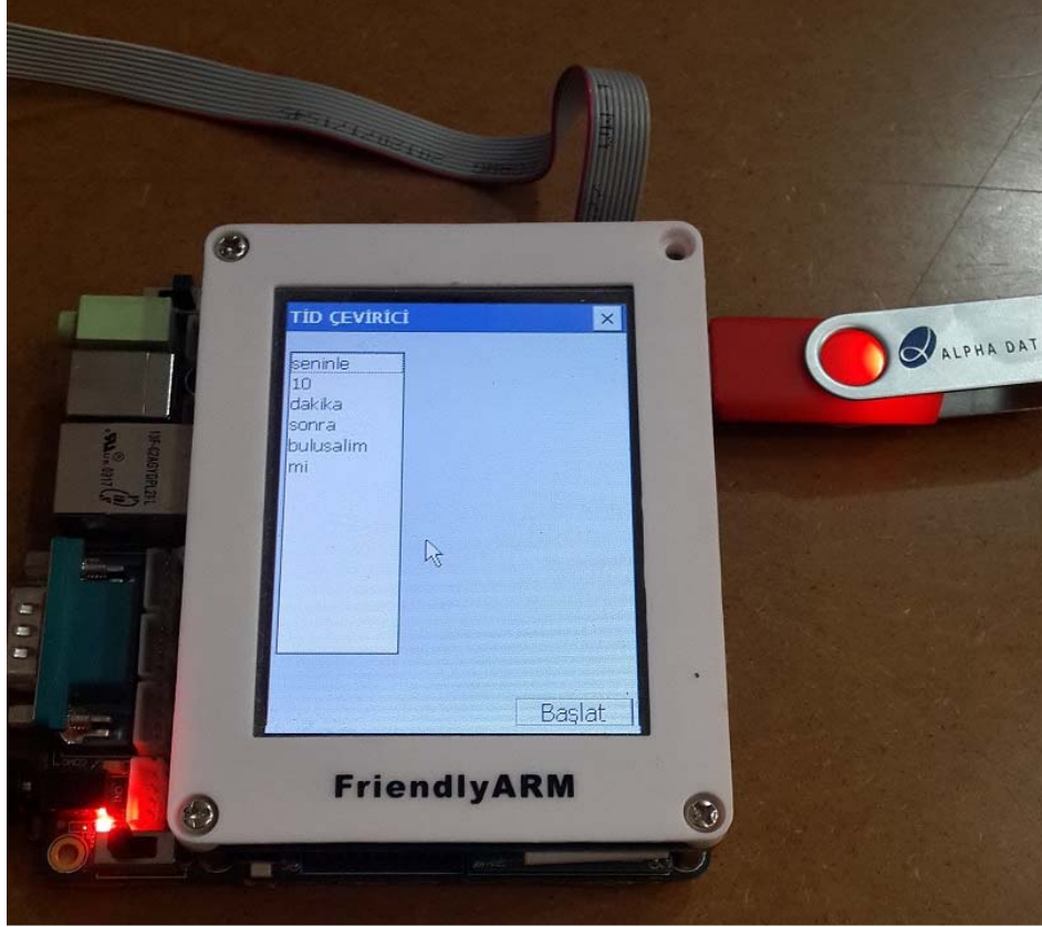
Şekil 5.6 Donanım üzerinde çakar bellek ve giriş metnin gösterilmesi
