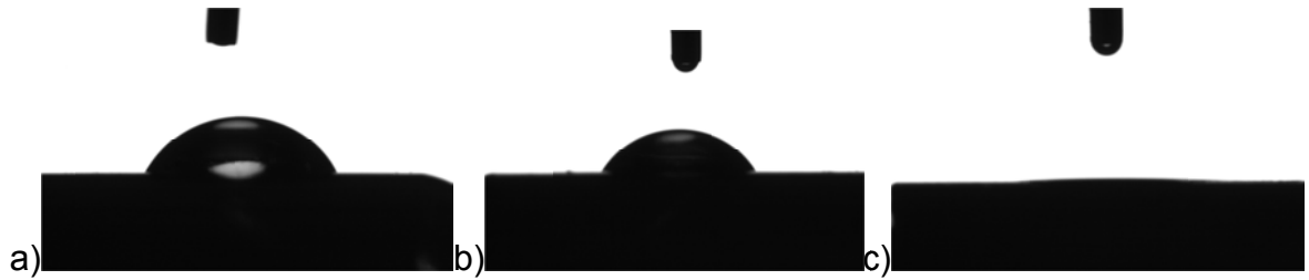
Şekil 4.20 a) İşlem görmemiş vida b)30W,10ml/dak,9dak parametrede kaplanan vida c) 30W,10ml/dak, 9 dakika aktive vida
