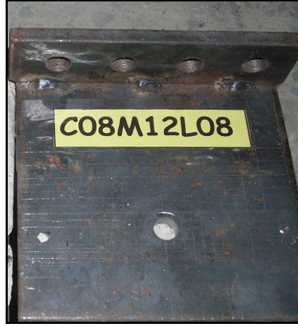
Resim 4.2.6. Karelaj yapılmış ve aparatların yerleşmesi için üzerine delikler açılmış çelik levha
