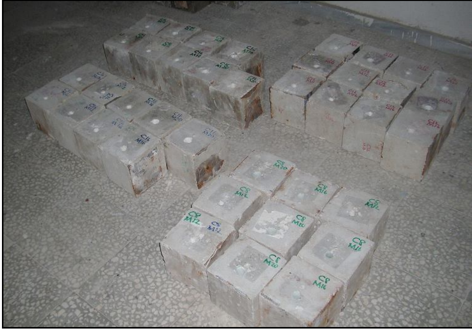
Resim 4.2.4. Deneyde kullanılacak sertleşmiş betonarme numuneler
