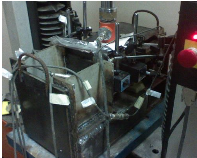
Resim 6.2.1. LVDT'lerin numune üzerine sabitlenmesi
