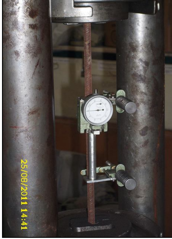
Resim 5.3.1. Donatı üzerinde çekme deneyinin yapılması
