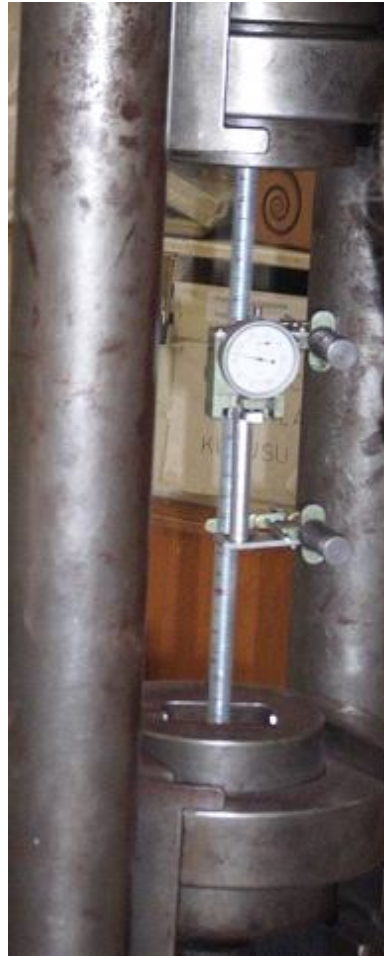
Resim 5.4.1. Ankraj bulonu üzerinde çekme deneyinin yapılması
