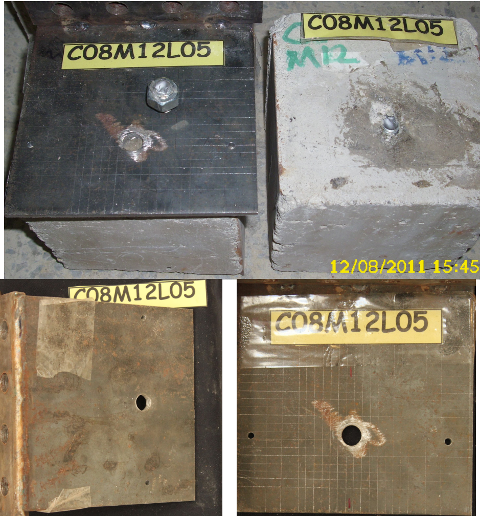
Resim 7.2.1. C8M12L05 numunesinde yük uygulandıktan sonra numunenin, üzerindeki çelik levha ve bulonun durumu
