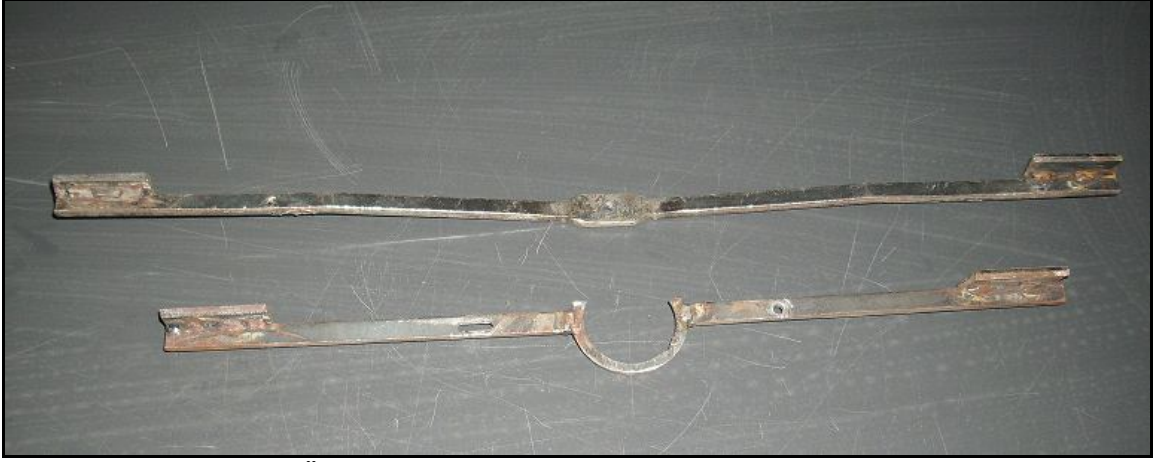
Resim 4.4.1. Ötelenme ölçümünde LVDT'lerin yerleştirileceği aparat
