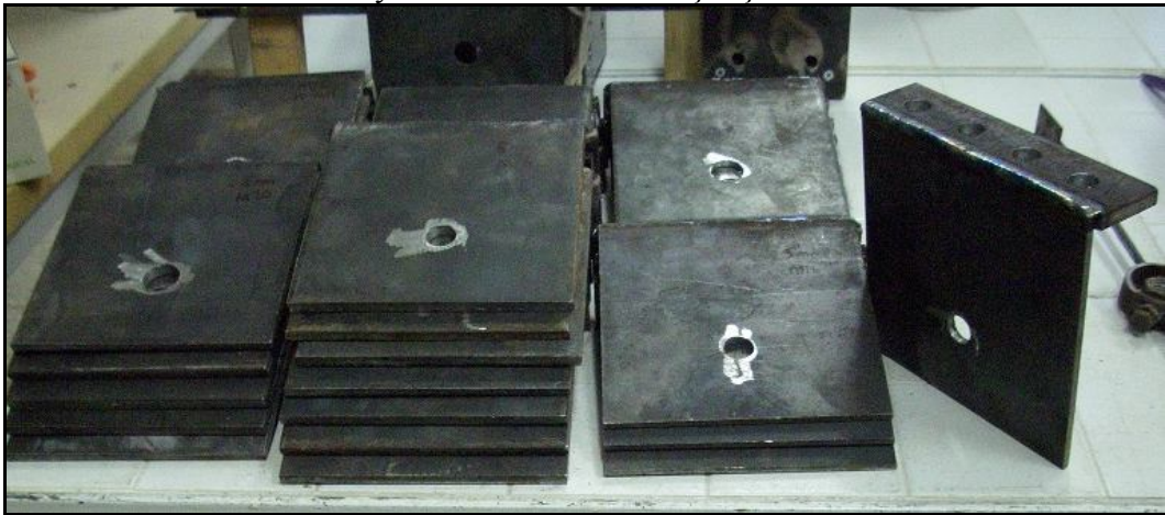
Resim 4.2.4. Deneyde kullanılacak sertleşmiş betonarme numuneler
