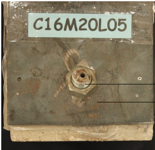
Resim 7.2.2. C6M20L05 numunesine yük uygulandıktan sonra numunenin, üzerindeki çelik levha ve bulonun durumu
