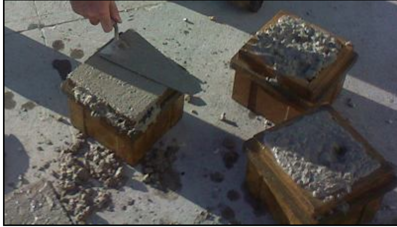
Resim 4.2.3. Hazırlanan betonun kalıp içersine yerleştirilmesi
