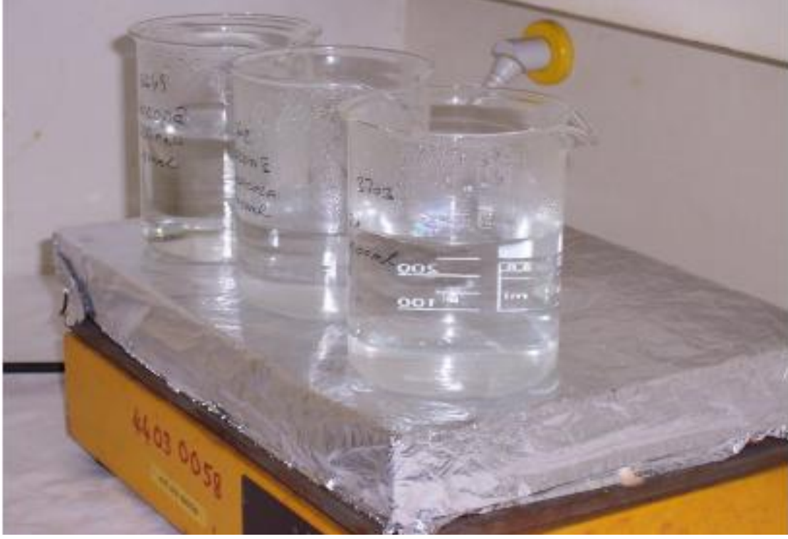
Şekil 3.11 Beher kaplarındaki su örneklerinin buharlaştırma işlemi
