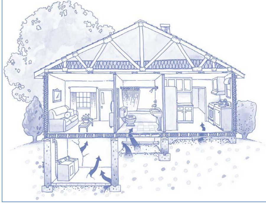
Şekil 2.10 : Radonun binalara giriş yolları.
