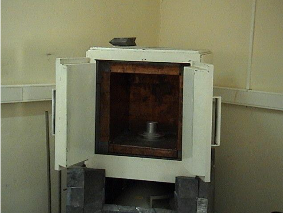
Şekil 3.4: Saf Germanyum dedektörlü gama spektrometrik cihazının çalışma düzeneği
