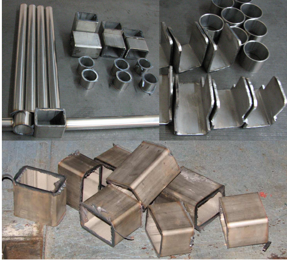
Şekil 3.40. Kolların imalatında kullanılacak CrNi alaşımlı çelik malzemeler.
