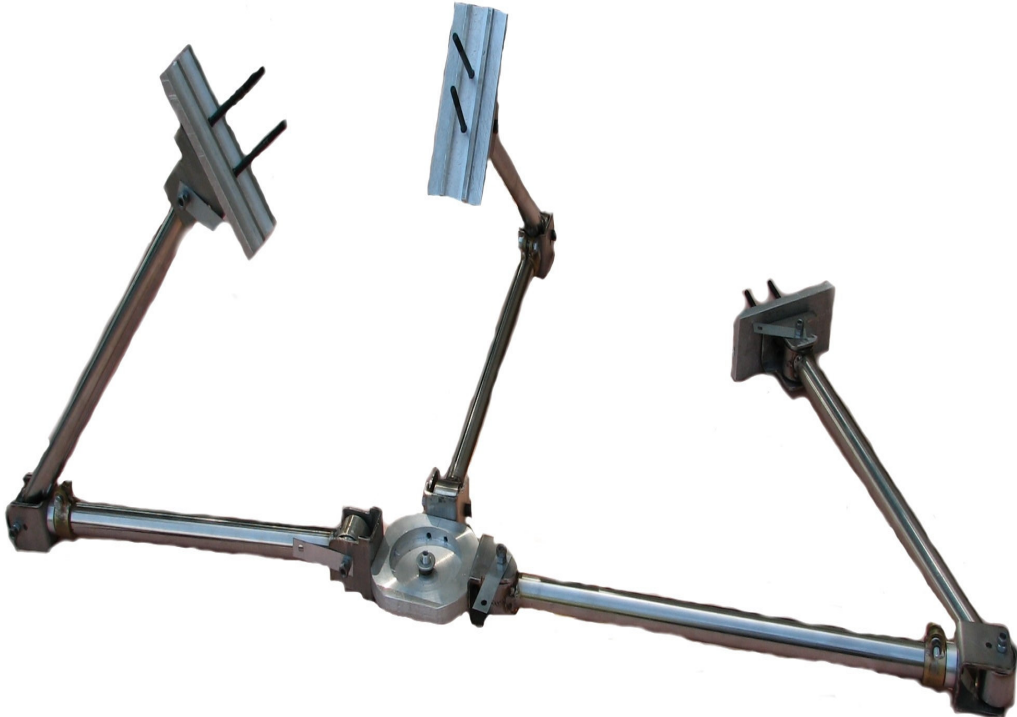
Şekil 3.43. Kolların ve taşıyıcı platformun montaj edilmiş hali
