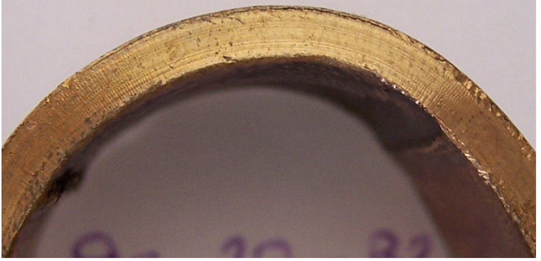
Şekil 4.17. 160 mm/dak ilerleme hızı ile kaynaklanmış 90/10 pirinç levhada kaynak tabanı iç tarafa gelecek şekilde yapılan 180° bükme numunesi
