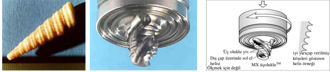
Şekil 2.6. MX Triflute™ takımın resim ve şematik çalışma şekli (THOMAS, 1998; SMITH ve ark., 2001; ÇAM, 2003; 2005a) (MX Triflute™ takımın esin kaynağı deniz kabuklarıdır)
