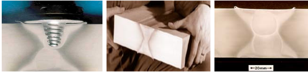
Şekil 2.5. 75 mm kalınlığındaki AA6082T6 alaşımının kaynağında Whorl™ takımının kullanılması, kaynağın bitmiş hali ve kaynak dikişinin görüntüsü (THOMAS, 1998; SMITH ve ark., 2001; ÇAM, 2003; 2005a; 2005b)
