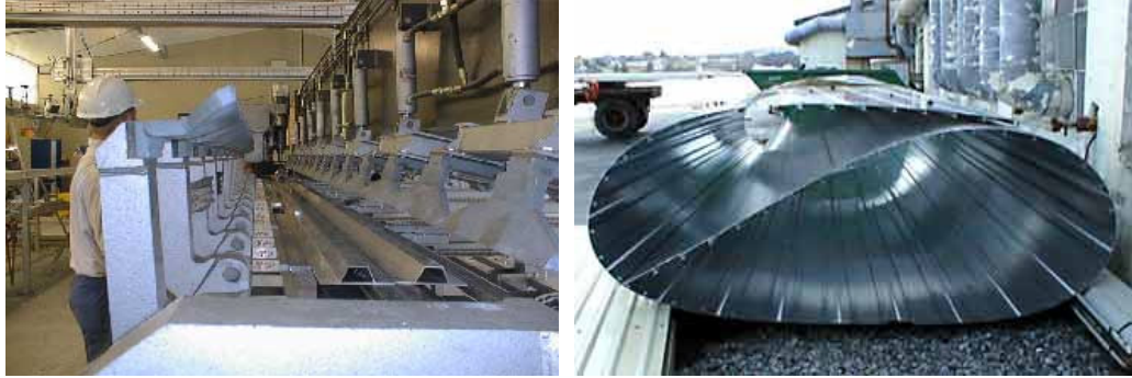
řekil 2.14. Yksek hız feribotlarında kullanılan alminyum ekstrzyon panellerinin Srtnme Karıřtırma Kaynađı ile birleřtirilmesi (ÇAM, 2003; 2005a; KALLE ve ark.,2001)
