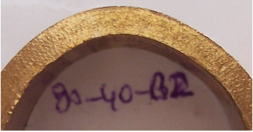
Şekil 4.19. 210 mm/dak ilerleme hızı ile kaynaklanmış 90/10 pirinç levhada kaynak tabanı iç tarafa gelecek şekilde yapılan 180° bükme numunesi
