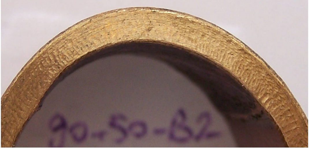
Şekil 4.21. 260 mm/dak ilerleme hızı ile kaynaklanmış 90/10 pirinç levhada kaynak tabanı iç tarafa gelecek şekilde yapılan 180° bükme numunesi
