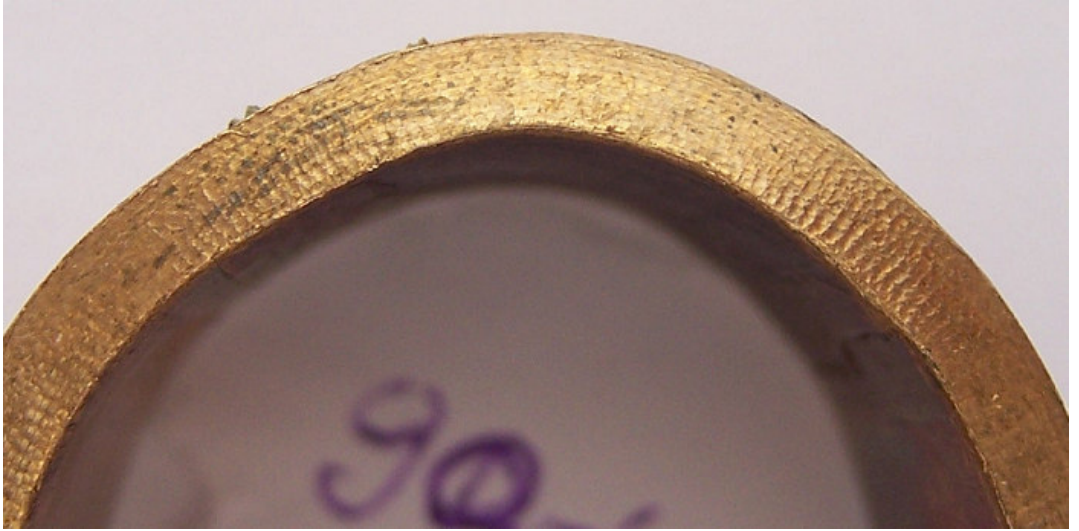
Şekil 4.18. 210 mm/dak ilerleme hızı ile kaynaklanmış 90/10 pirinç levhada kaynak tabanı dış tarafa gelecek şekilde yapılan 180° bükme numunesi
