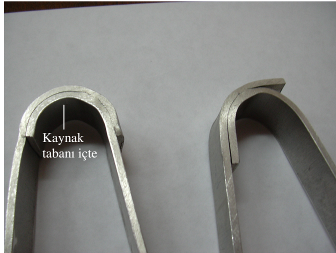
Şekil 4.4. Al-levhalarda kaynak dikişinin tabanı içe gelecek şekilde yapılan 180° bükme numuneleri.
