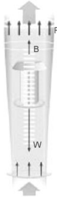
Şekil 3.9. Rotametre sistemine etkiyen kuvvetler (ANONYMOUS, 2004)
