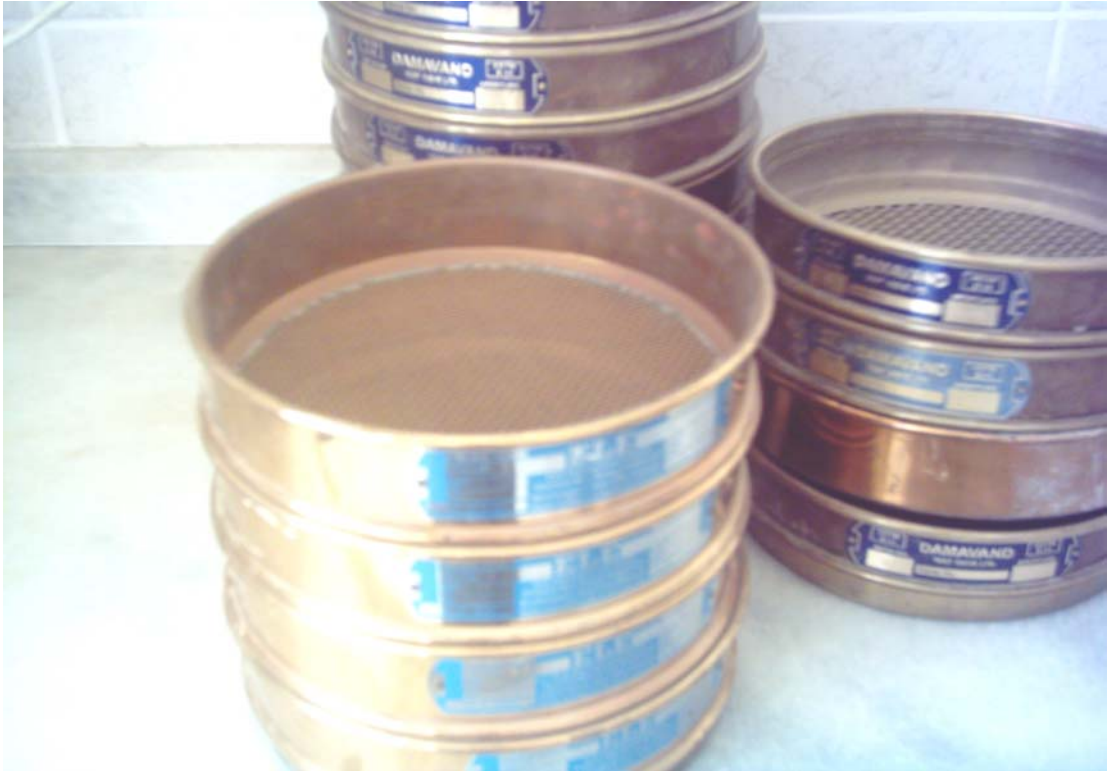
Şekil 3.9. Elek Analizi İçin kullanılan Elekler
