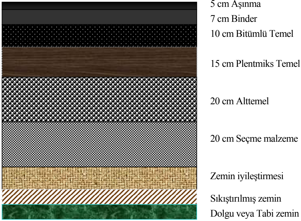
Şekil 3.1. Bitümlü sıcak karışım üstyapı tipi
