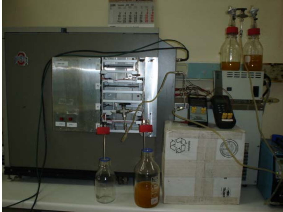
Şekil 3.1. Deneyleerde kullanılan laboratuvar ölçekli PEF sistemi.
