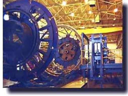
Şekil 2.15. Space Shuttle External Tank projesi ve Marshall Space Flight Center laboratuvarındaki Sürtünme Karıştırma Kaynak sistemlerinden görüntüler (Serindağ, 2006; Çam, 2003; 2005a; Kalle ve ark.,2001'den)
