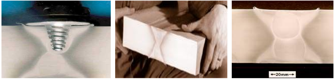
Şekil 2.5. 75 mm kalınlığındaki AA6082-T6 alaşımının kaynağında Whorl™ takımının kullanılması, kaynağın bitmiş hali ve kaynak dikişinin görüntüsü (Smith ve ark., 2001; Çam, 2003; 2005a; 2005b)
