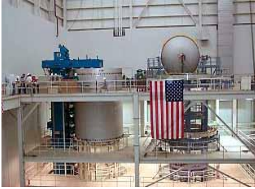
Şekil 2.15. Space Shuttle External Tank projesi ve Marshall Space Flight Center laboratuvarındaki Sürtünme Karıştırma Kaynak sistemlerinden görüntüler (Serindağ, 2006; Çam, 2003; 2005a; Kalle ve ark.,2001'den)
