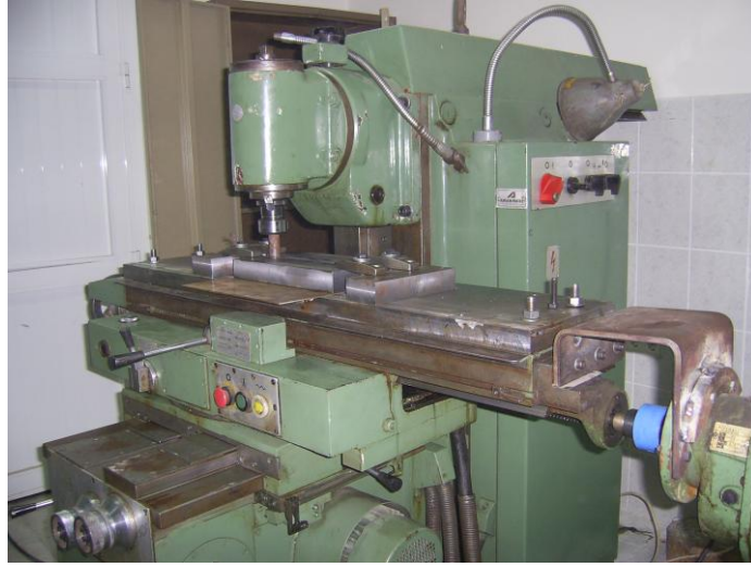
Şekil 3.2. Sürtünme karıştırma kaynağı işleminin yapıldığı dik freze tezgahı
