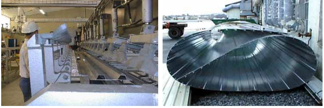
Şekil 2.14. Yüksek hız feribotlarında kullanılan alüminyum ekstrüzyon panellerinin Sürtünme Karıştırma Kaynağı ile birleştirilmesi (Serindağ, 2006; Çam, 2003; 2005a; Kalle ve ark.,2001'den)
