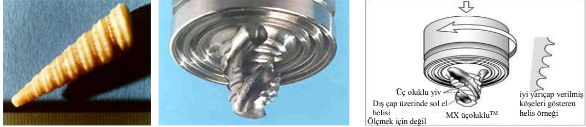
Şekil 2.6. MX Triflute™ takımın resim ve şematik çalışma şekli (Smith ve ark., 2001; Çam, 2003; 2005a) (MX Triflute™ takımın esin kaynağı deniz kabuklarıdır)
