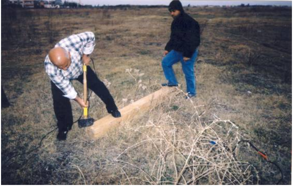
Şekil 3.4. Arazide balyozla S dalgası üretimi
