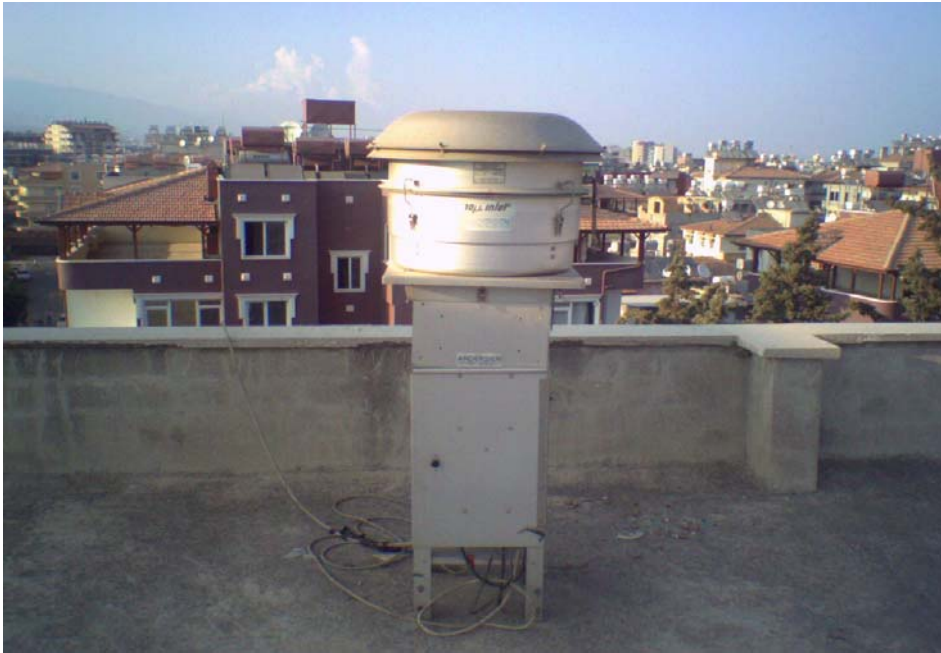
Resim 3.1. Hava örneklerinin toplandığı yüksek hacim hava örnekleme cihazı
