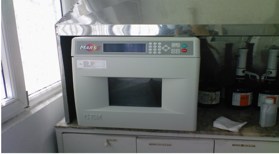
Resim 3.4. Filtre kağıtlarının çözünürleştirildiği mikrodalga fırın
