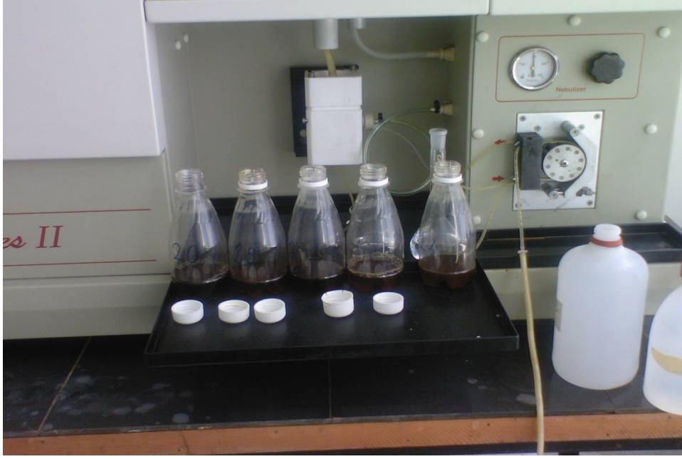
Resim 3.7. Çözünürleştirilen filtre kağıtlarının cihaza verilmesi
