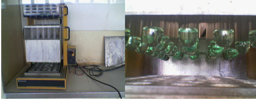
Şekil 3.2. Protein analizinde kullanılan Gerhardt yağ yakma ünitesi
