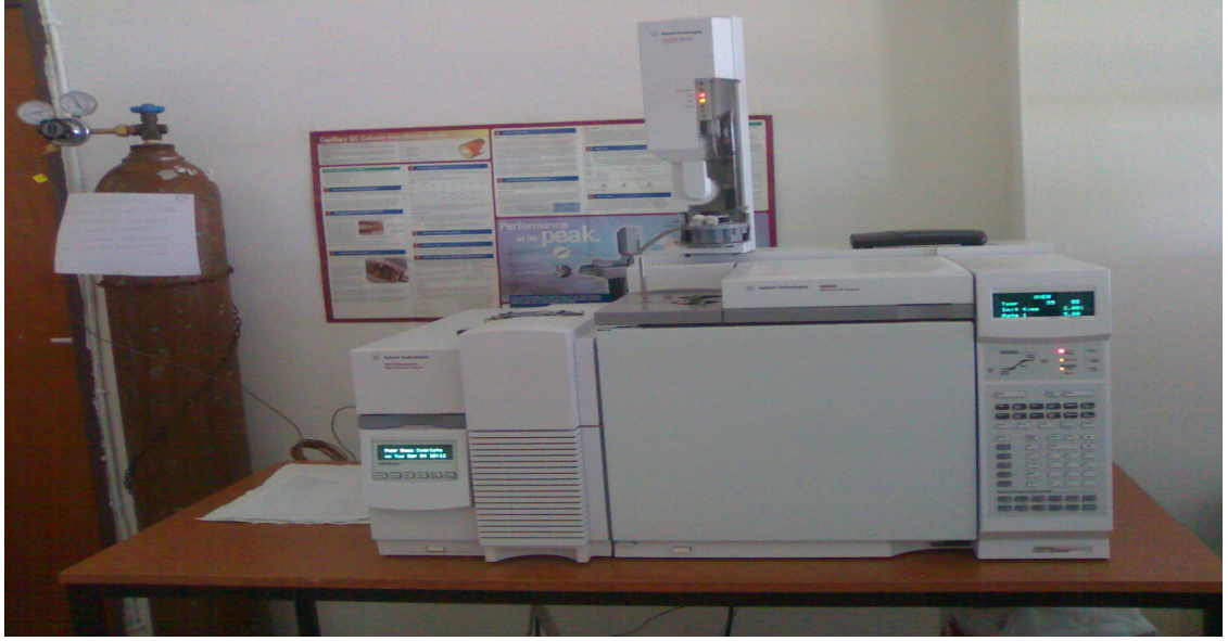
Şekil 3.3. Gazkromatografisi/Kütlespektrometresi (6890/5973N model-Agilent, Amerika)
