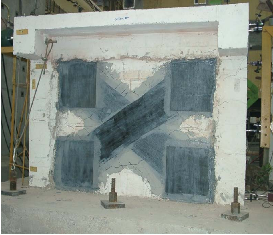
Şekil 4.24. Dolgu Duvarlarının Lifli Polimerler ile Güçlendirilmesi
