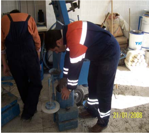
Şekil 3.9. Ve-Be Deneyi Fotoğrafları
