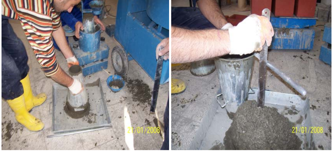
Şekil 3.7. Slump(Çökme) Deneyi Fotoğrafları
