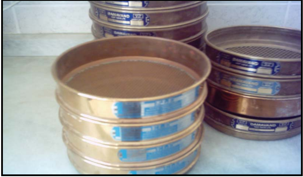
Şekil 3.9. Elek Analizi İçin Kullanılan Elekler
