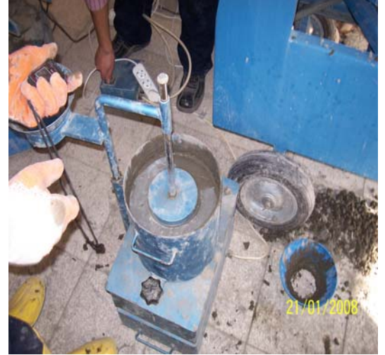
Şekil 3.9. Ve-Be Deneyi Fotoğrafları
