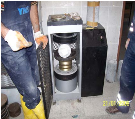
Şekil 3.12. Beton Presinde Silindir Yarma Deneyi Fotoğrafları
