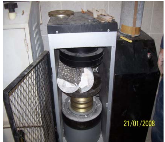
Şekil 3.12. Beton Presinde Silindir Yarma Deneyi Fotoğrafları
