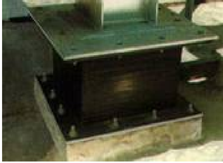
Şekil 3.5. Kurşun Çekirdekli Kauçuk İzolatör
