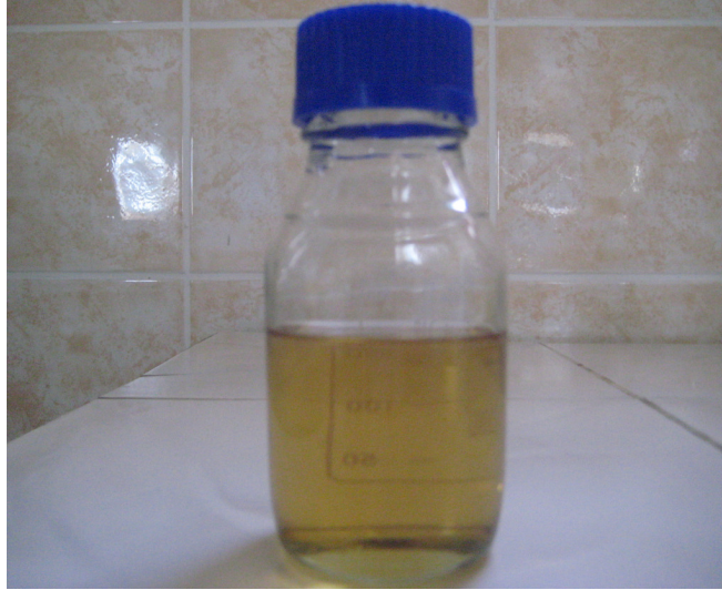
Şekil 3.2.1. Biyodizel-dizel karışımında faz ayrışımı yok
