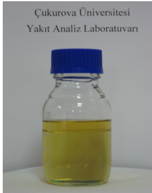
Şekil 3.2.2. Biyodizel-dizel-etenol (%99,5 saflık) karışımında faz ayrışımı bulunmaktadır.
