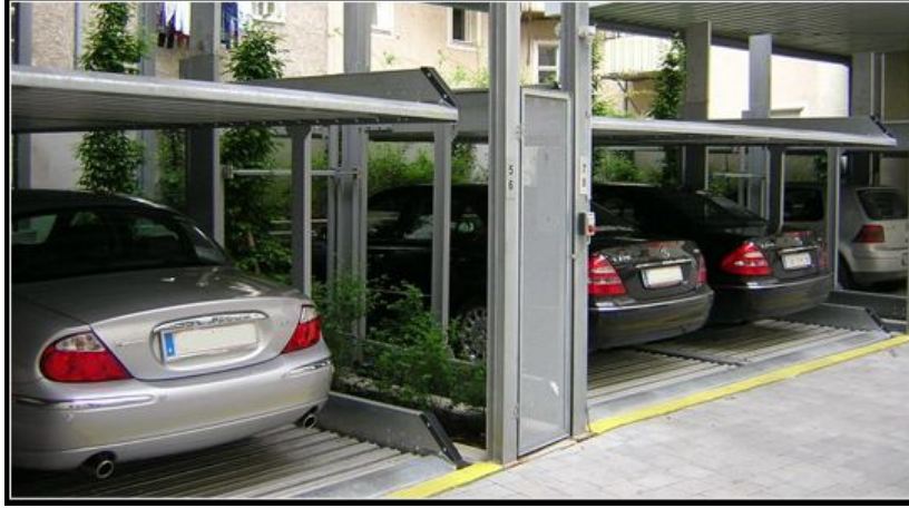
Şekil 4.22. Otomatik Otopark Sistemi Yapısı (Anonymous, 2008b)
