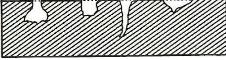
Şekil 1.4. Çukurcuk korozyonu (Eker, 2008)
