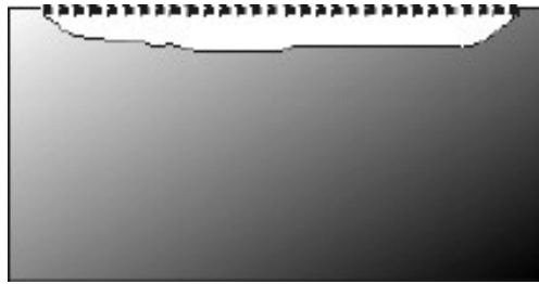
Şekil 1.2. Homojen dağılımlı korozyon (www.corrosion-doctors.org)
