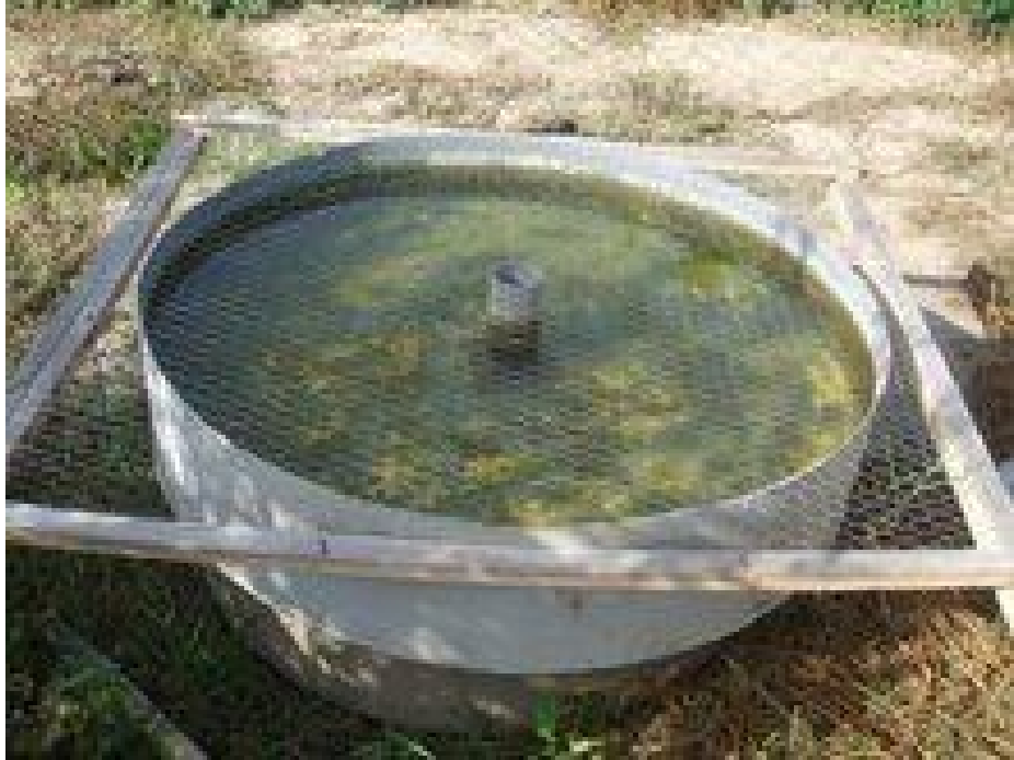
Şekil 3.3. Buharlaşma kabının (Class A Pan) konumlandırılması
