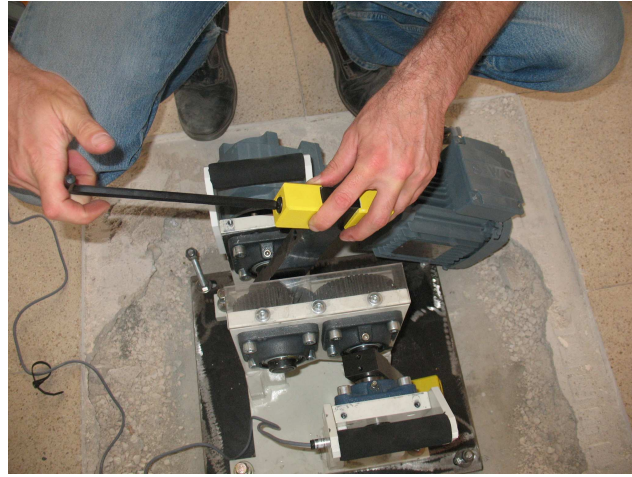
Şekil 3.11. Kollara ağırlıkların yüklenmesi
