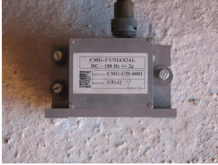
Şekil 3.8. Sarsma Cihazı-Tip1 ile birlikte kullanılan ivme ölçer
