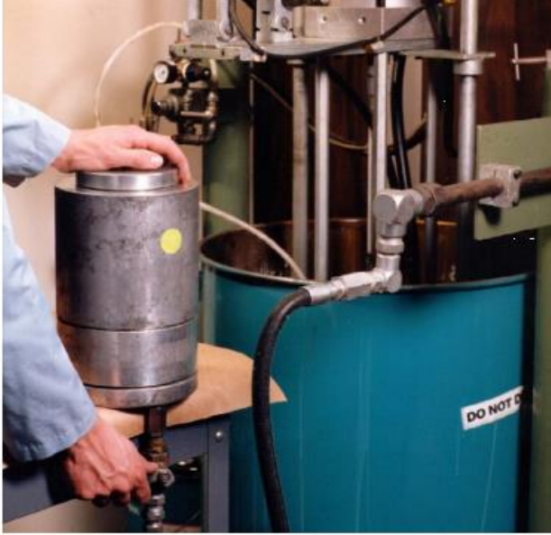
Resim 3.4. Kalıpların İzostatik Prese Yerleştirilmesi
