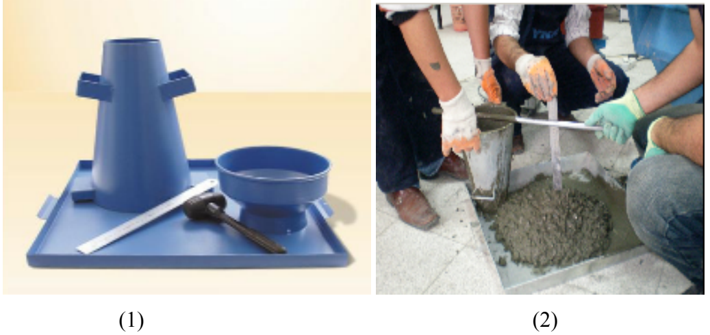
Şekil.3.1 Slump (Çökme) Deneyi–(1) Deney aletleri–(2) Uygulama
