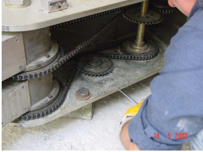
Şekil 3.7 Titreşim yönünün değiştirilmesi
