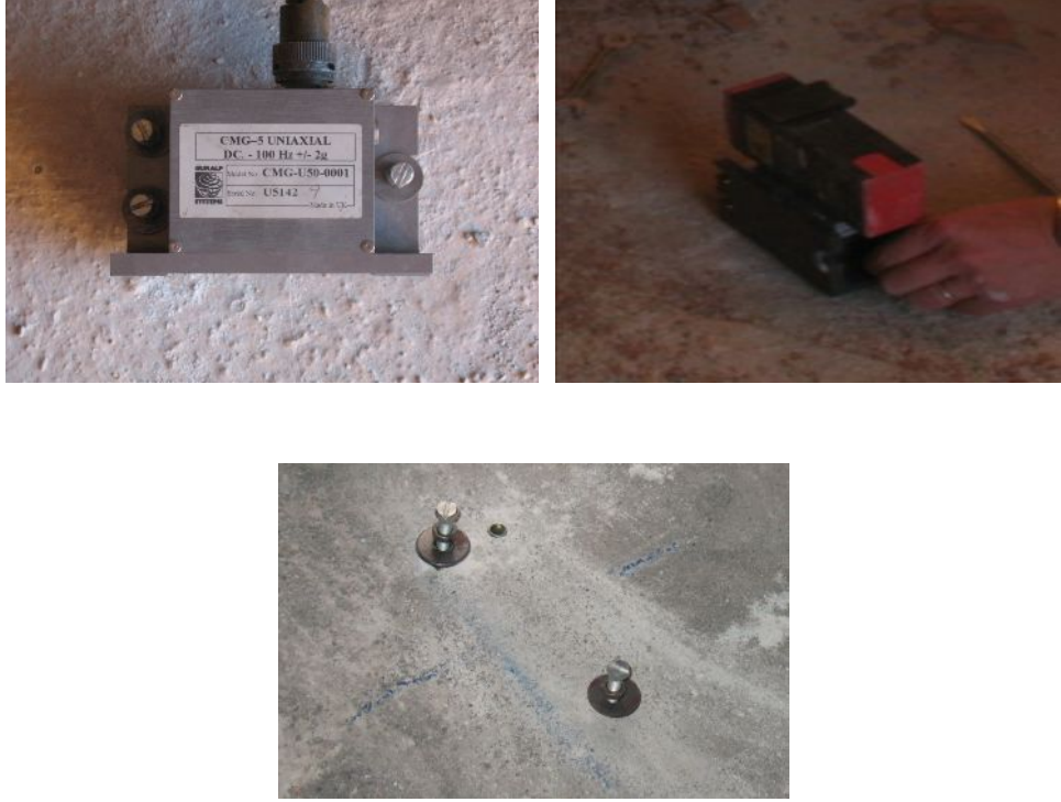
Şekil 3.15 Dübeller yerleştirilir, ivmeölçer monte edilir ve su terazisi ile dengelenir
