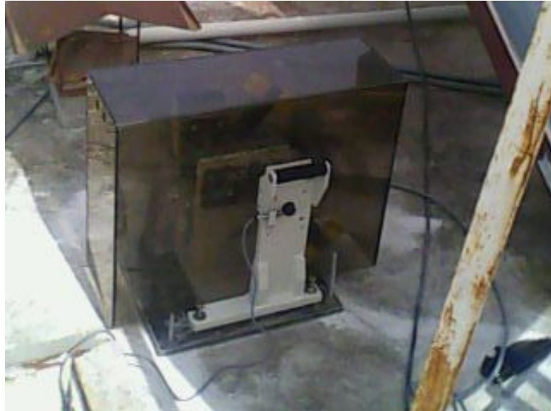
Şekil 3.20 Titreşim üreticiye takılan koruma kutusu
