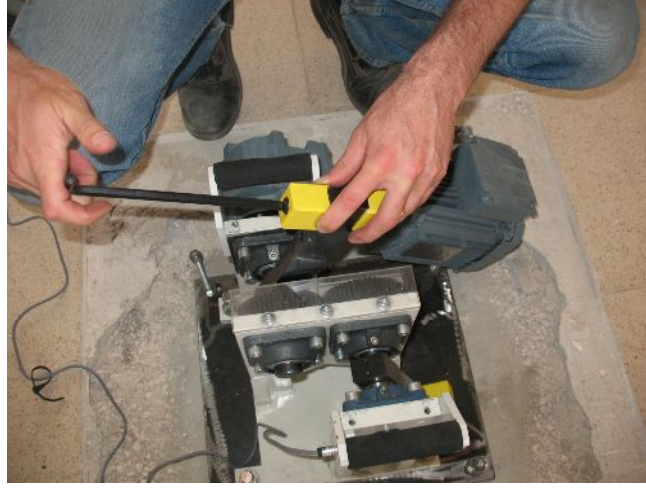
Şekil 3.10 Ağırlıkların sarsma kollarına yerleştirilmesi
