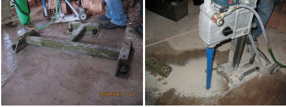
Şekil 3.14 Montajı yapılmış demir sehpa ve karot makinesi
