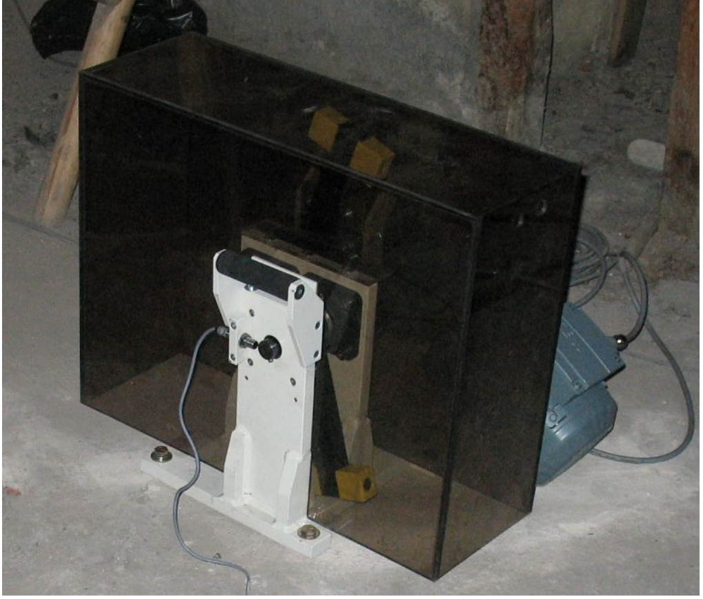
Şekil 5.26 Titreşim üreticinin binaya monte edilmiş hali
