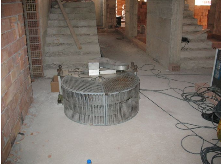
Şekil 5.3 Titreşim üreticinin binaya monte edilmiş hali
