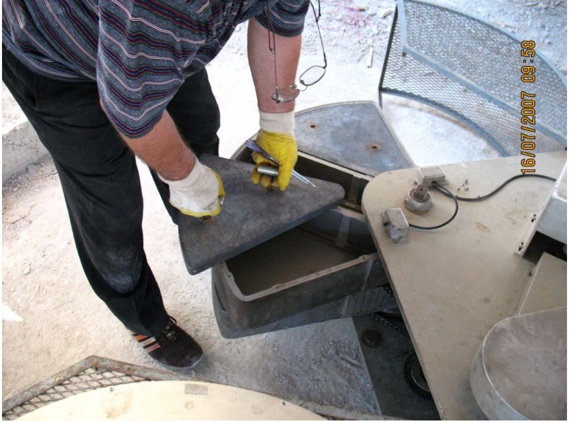
Şekil 3.5 Kurşun ağırlıkların kovalara yüklenmesi
