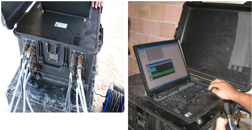
Şekil 3.16 Kablo bağlantıları ve data toplama ünitesinin genel görüntüsü
