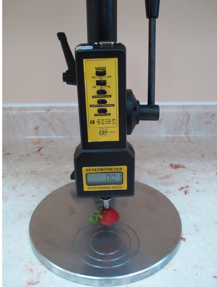
řekil 3.8. Meyve eti sertlik ölçümlerinin yapıldığı meyve eti sertlik ölçer.
