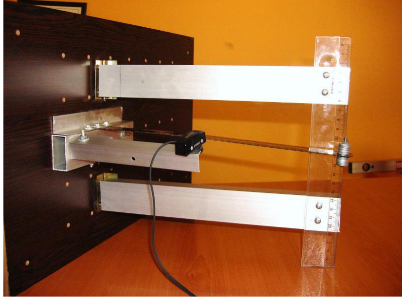
Şekil. 3.17. Esneme Ölçümü Yapılması.
