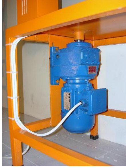
Şekil.3.47. Sarsma Tablası motoru ve redüktör.
