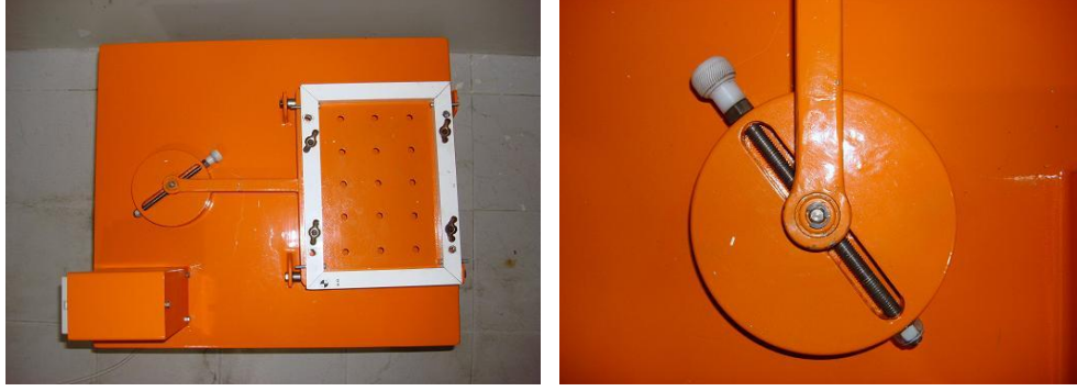
Şekil. 3.48. Sarsma tablası eksantrik disk mekanizması.
