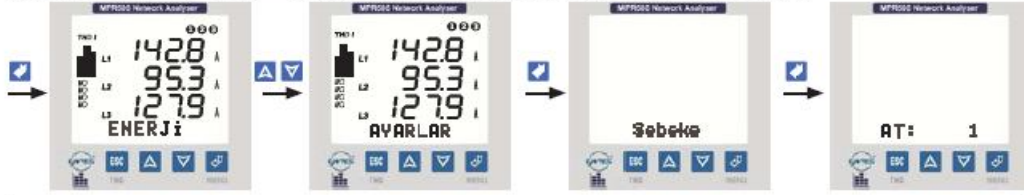
Şekil 11: Akım trafosu çeviri oranı ayarı
