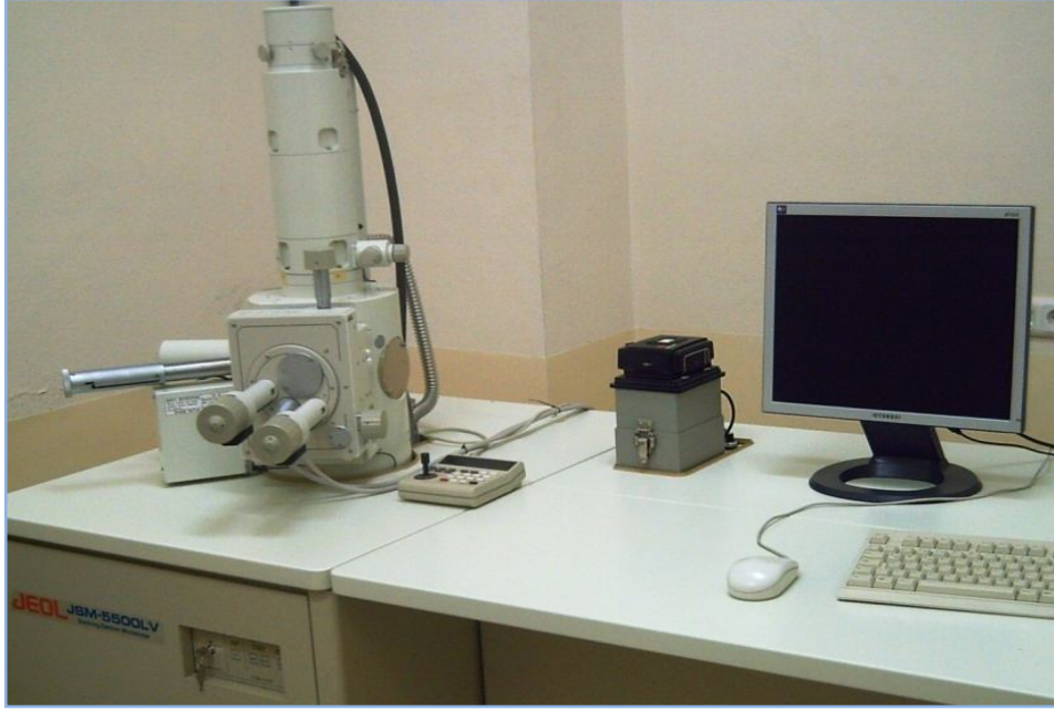
Şekil 3.18. Tez çalışmasında kullanılan taramalı elektron mikroskobu (SEM)(Mustafa Kemal Üniversitesi Fen Bilimleri Araştırma ve Uygulama Merkezi)
