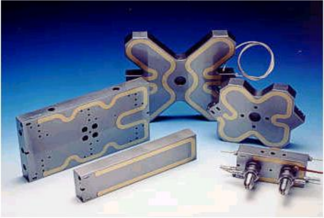
Şekil 3.9. Temel manifold şekilleri.
