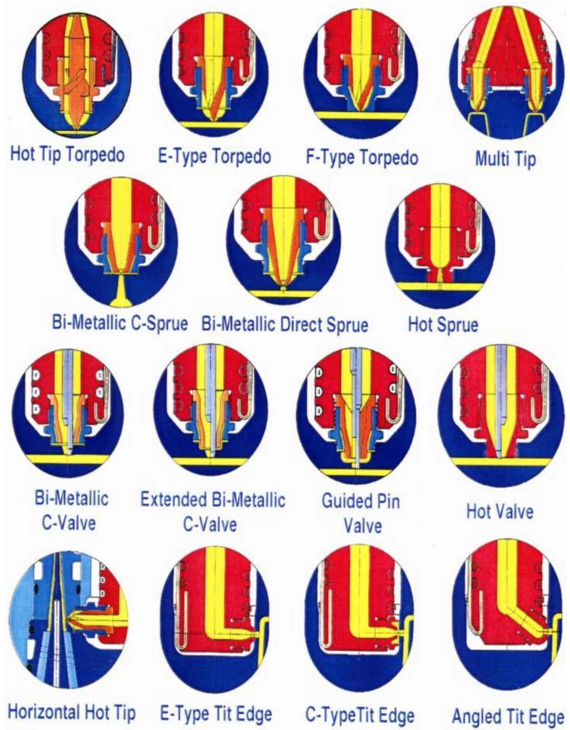
Şekil 3.20. Mold Masters'ın yolluk giriş ucu seçenekleri
