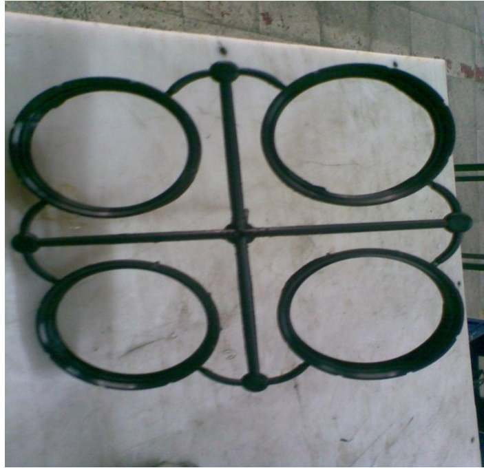
Şekil 4.2. M80x2,5 plastiğın kalıptan çıkmış hali
