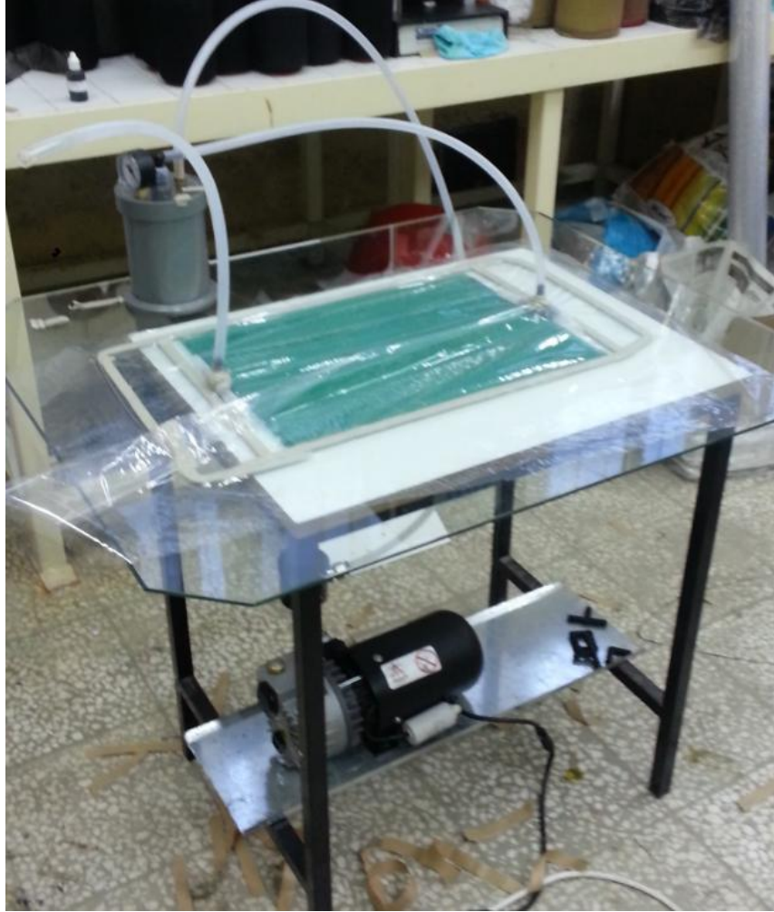
Şekil 4 1 Vakum İnfüzyon Yöntemiyle Kompozit Üretimi
