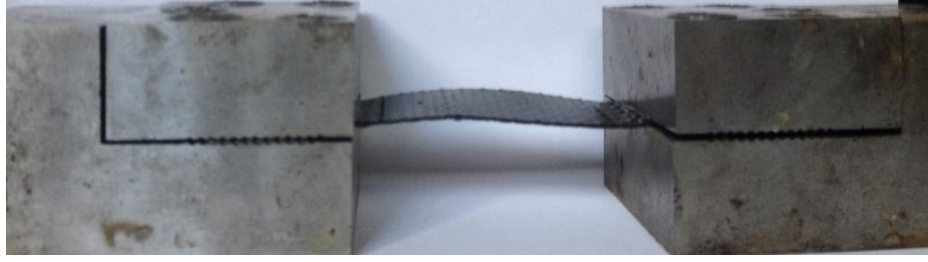
Şekil 4 8 Tek Kat. Dokuma Karbon/ Vinlester Kompozitte Termal Burkulma Davranışı Mod Şekli (Mod1)
