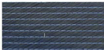
Şekil 3 4 İki eksenli (+45/-45) Karbon Elyaf Kıvrımsız Tekstil Destek Ürünü
