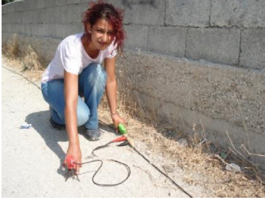
Şekil 4.2. 4.5 Hz frekanslı P jeofonları
